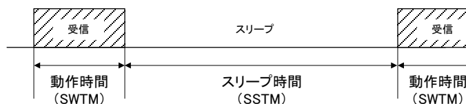
図 8 間欠受信動作の概要
