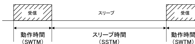
図5 間欠受信動作の概要
