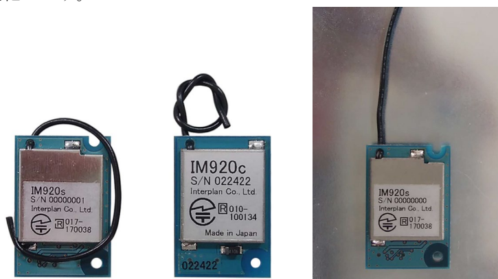
図9 良くない例 (グラウンドに接近 ワイヤアンテナが丸まっている 金属板に近い)
